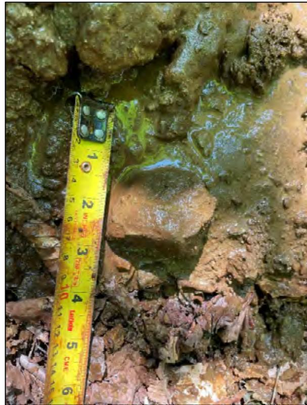
Photo 7 : Sondage à la tarière (ici 23F-3), présence de bloc en contact avec le roc
