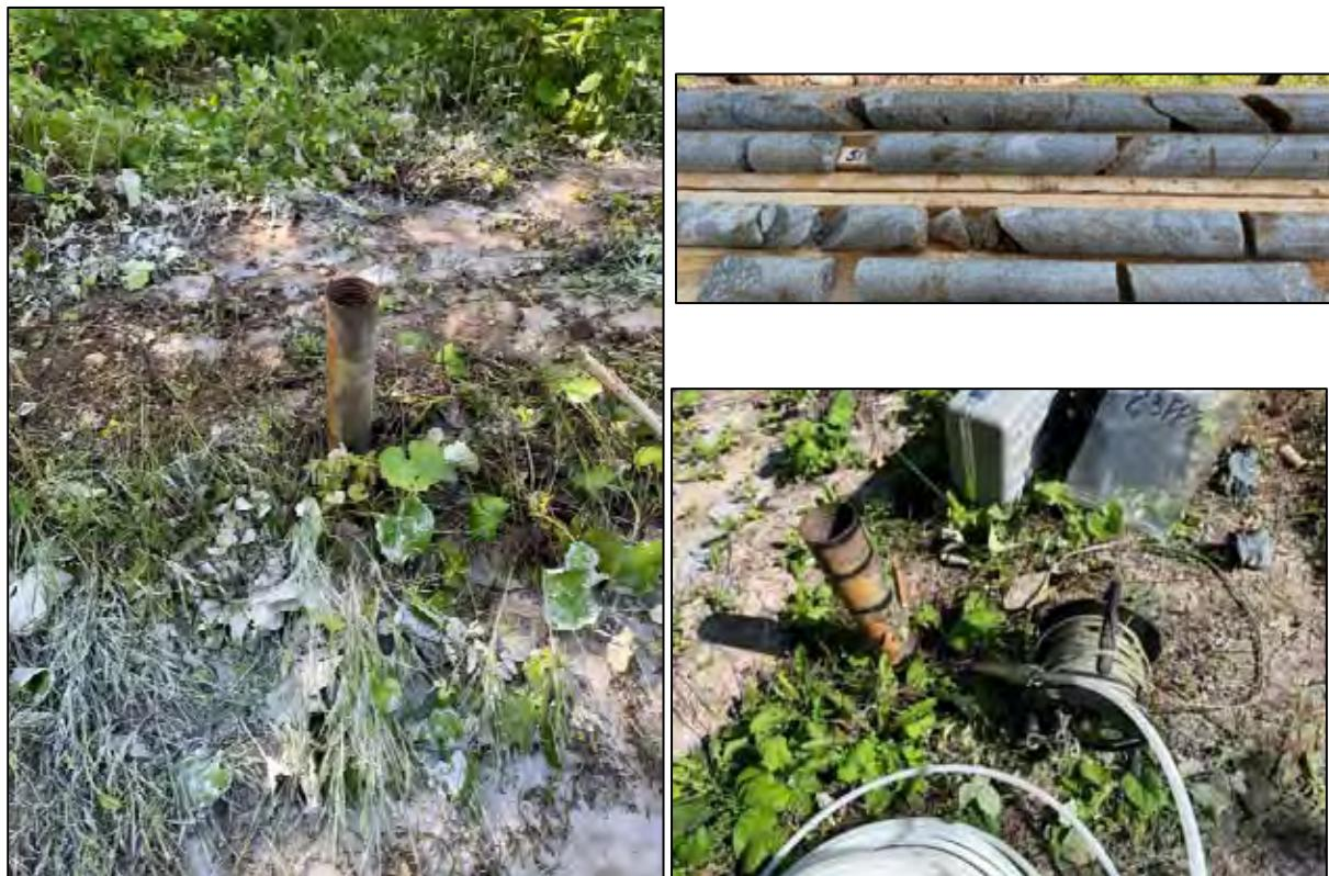
Photo 11 : Puits de pompage 23PP-2, type de carotte et kit d'installation pour un essai de pompage à faible débit
